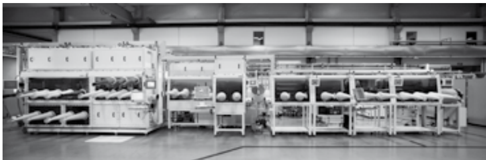
Die Pilotanlage für lösungsbasierte Prozesse am Fraunhofer IAP steht in einem Reinraum und ist 15 Meter lang /// Foto © MBRAUN
