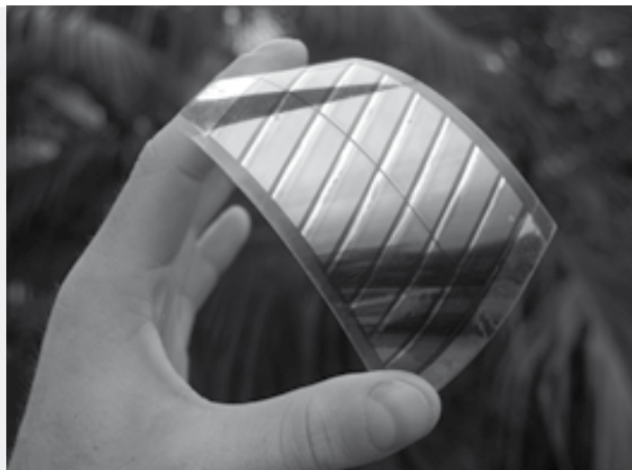
Die neu entwickelten organischen Solarzellen sind besonders dünn und sehr flexibel /// Foto © Flexsolar, Bernard Schmidt
